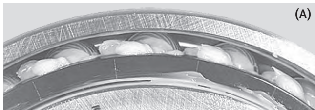
Místa plnění mazivem (ložisko s textitovou klecí vedenou vnějším kroužkem)
